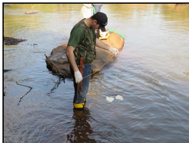
Figura 6.25 – Mensuração da profundidade e transparência do local de coleta.
