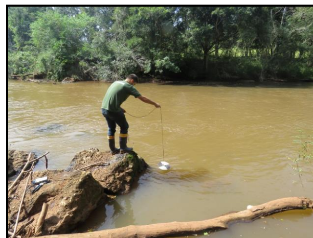
Figura 6.27 – Mensuração dos níveis de oxigênio dissolvido, saturado e temperatura da água.
