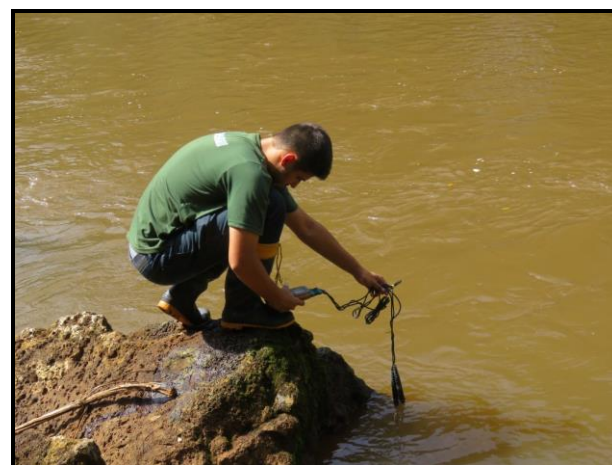
Figura 6.27 – Mensuração dos níveis de oxigênio dissolvido, saturado e temperatura da água.
