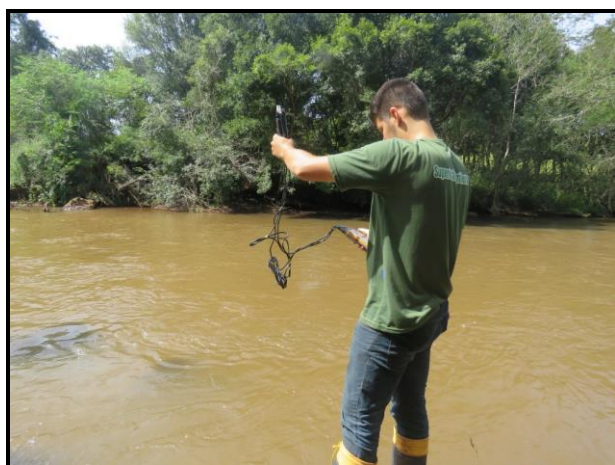
Figura 6.26 – Verificação da temperatura do ar no momento da amostragem.
