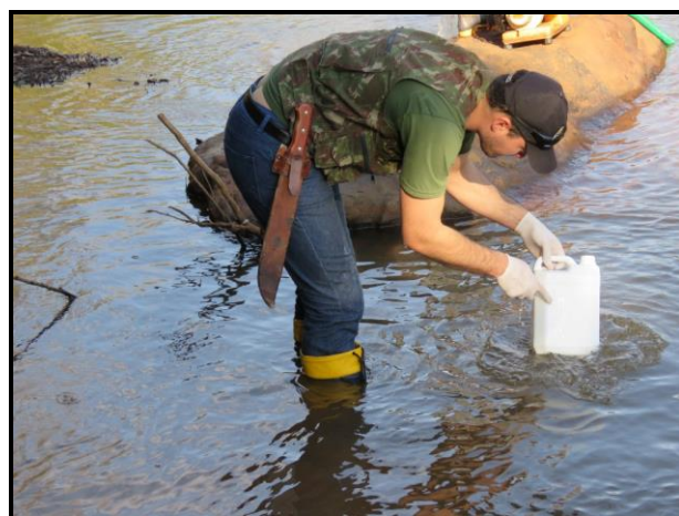
Figura 6.23 – Procedimento de coleta de amostra para análises físico-químicas.
