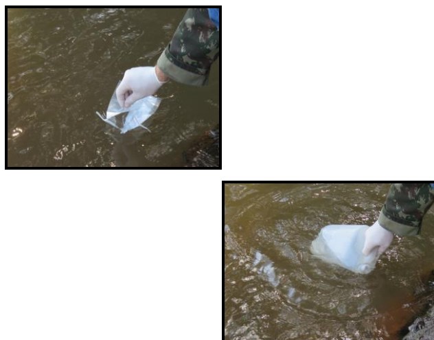
Figura 6.28 – Procedimento de coleta de amostra para análises microbiológicas e físico-químicas.
