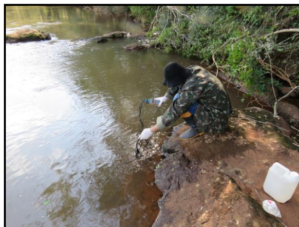
Figura 6.21 – Mensuração dos níveis de oxigênio dissolvido, saturado e temperatura da água.
