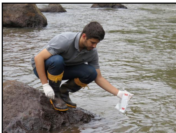
Figura 6.22 – Procedimento de coleta de amostra para análises microbiológicas.
